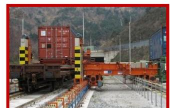
Die Fahrwerke werden je von einer elektrischen, PLC gesteuerten Einheit kontrolliert und versorgt. Gemäß der Ausmaße der zu bewegenden Transporteinheit **positionieren sich** die Fahrwerke **automatisch**.
