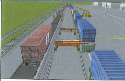
BILD 1: Der Shuttle (orangefarbig) fährt seine Ladefläche unter den zu verladenden Container und hebt diesen an
