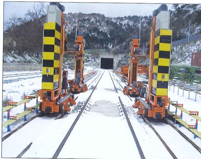
BILD 4: Die vier Hebesäulen des Metrocargo-Systems
