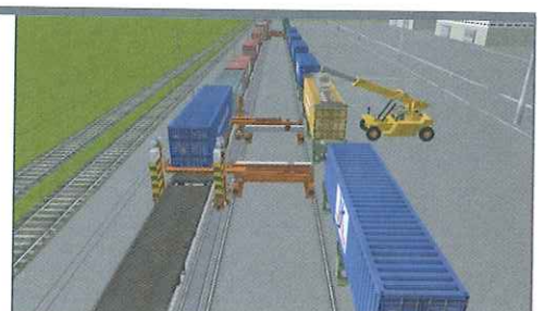
BILD 3: Der Container wird mit Hilfe der vier Hebesäulen über dem Containertragwagen positioniert und abgesetzt
