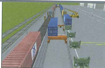
BILD 2: Der Container wird mit dem Shuttle zur richtigen Position auf Höhe des leeren Containertragwagens gefahren
