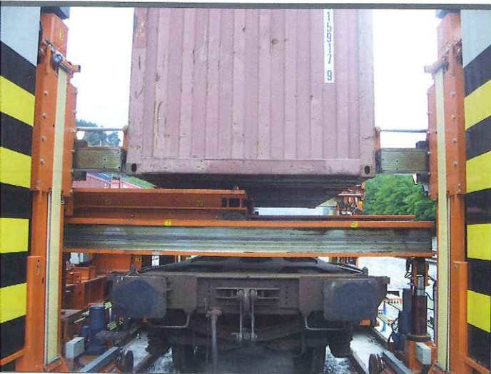
BILD 5: Ein Container wird oberhalb des Containertragwagens von den Hebesäulen angehoben. Der Shuttle (orange-farbig) bewegt sich darunter
